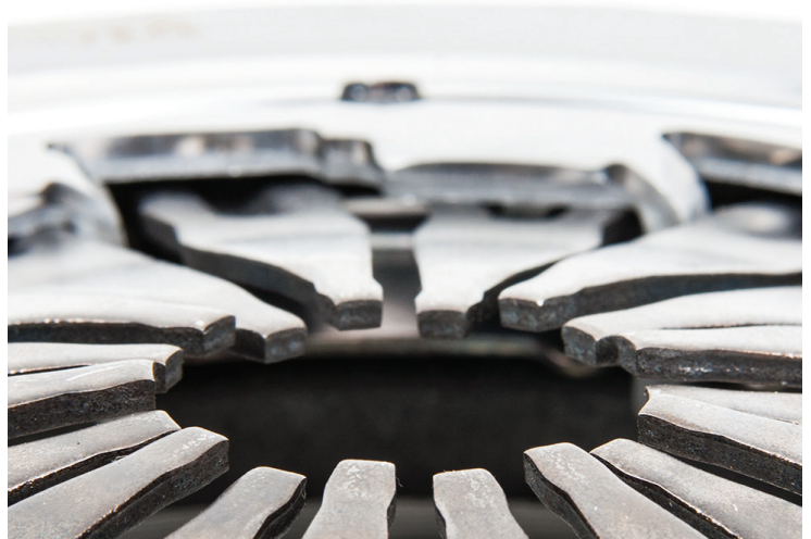
Fig. 1: Hoogteverschil van de diafragmaveertongen bij gedemonteerde koppeling
