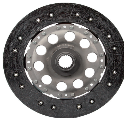
Fig. 2: Disco de embrague del equipamiento original (diámetro de 240 mm)
