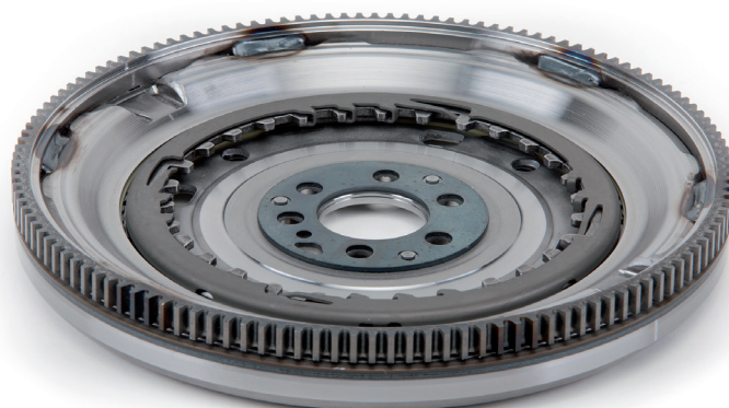
Immagine 1: il numero di denti della corona del nuovo componente deve corrispondere a quello del componente da sostituire
