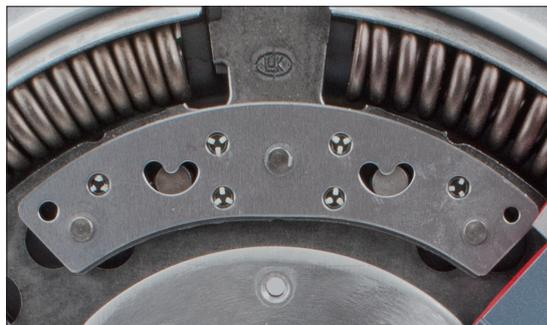
Fig. 2: Péndulo centrífugo
