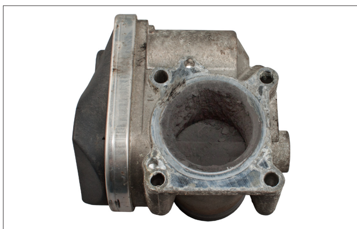
Fig. 1: Verontreinigingen in het gasklep huis moeten worden verwijderd
