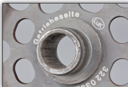
Fig. 2: Perfil del buje dañado
