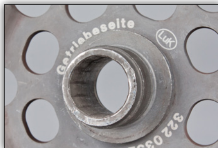
Figura 2: Dentatura del mozzo danneggiata
