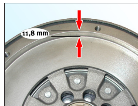
Image 2: 415 0239 10 / 415 0243 10 (Nouvelle version de volant moteur bimasse)
