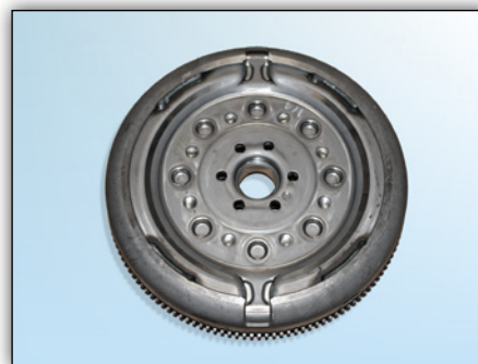
Image 7 : Côté moteur sans rainure sur le volant bimasse Sachs
