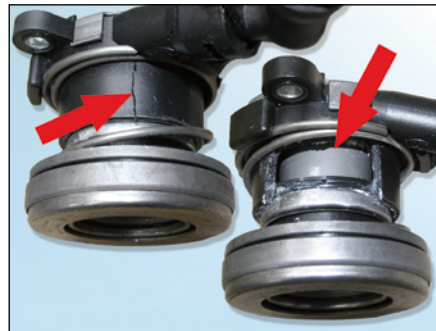
Figura 5: Attuatore concentrico rotto irrimediabilmente a causa di un montaggio errato
