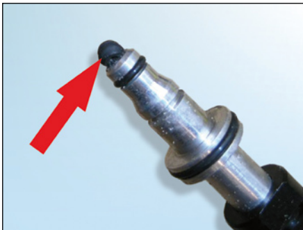
Figura 4: Se la vecchia guarnizione non viene rimossa, questa si sposterà in direzione del CSC bloccando il cavo
