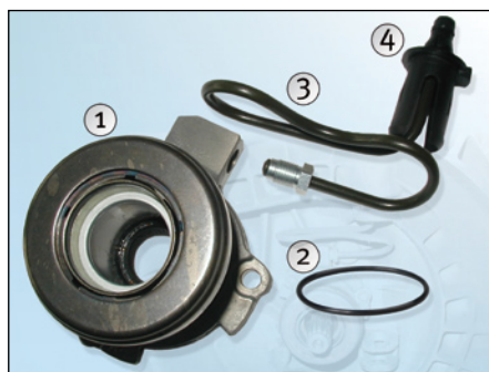
Image 1 : Ne pas réutiliser les éléments (ci-dessus) préalablement montés.
