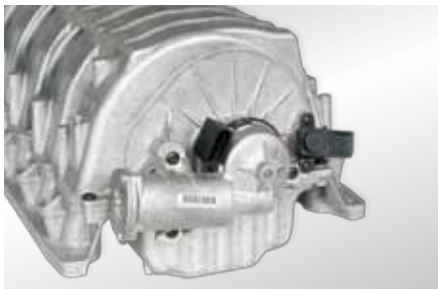
Módulo impulsor en tubo de aspiración
