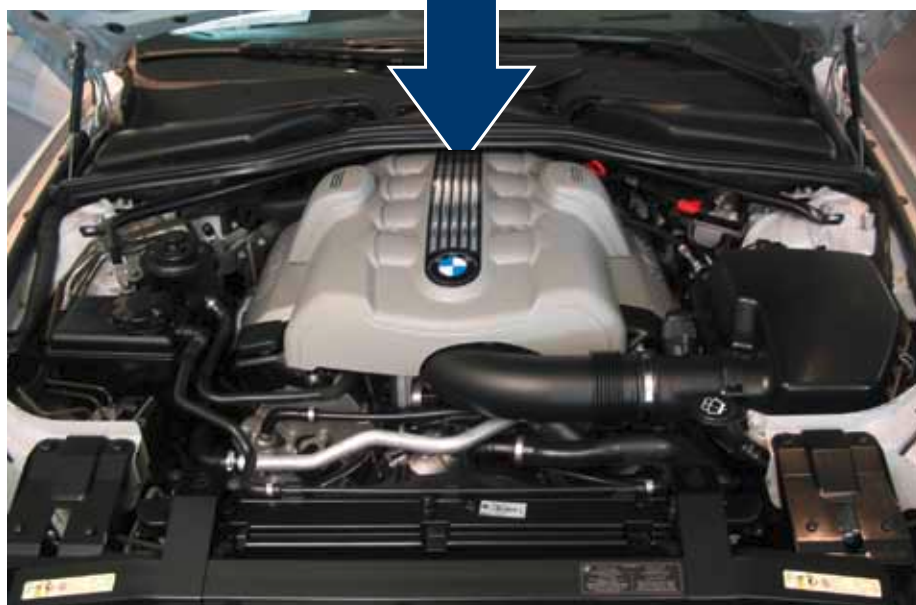
Emplacement du module d'entraînement dans le moteur BMW 645i
