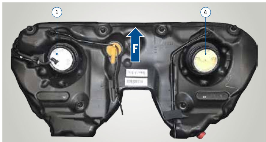
Fig. 4 : réservoir de carburant (vue de dessus)
