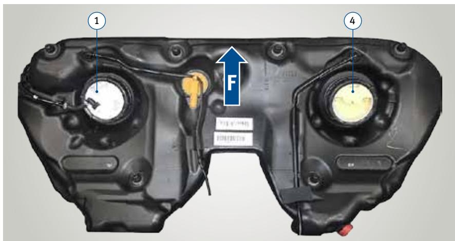
Abb. 4: Kraftstofftank (Draufsicht)
