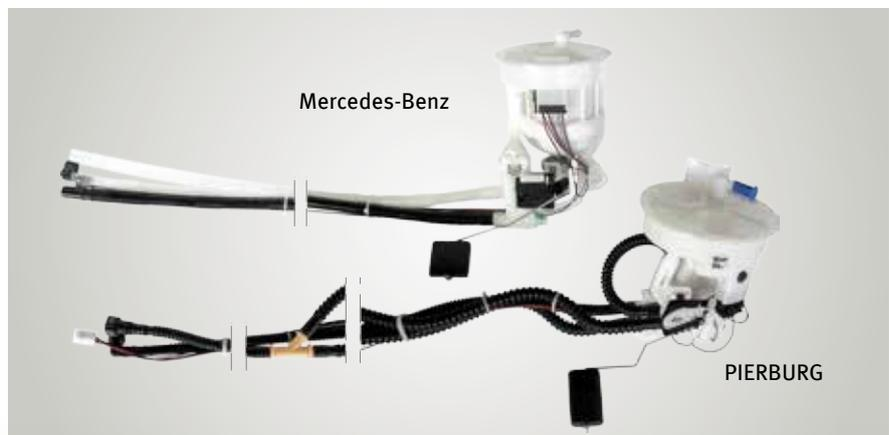
Abb. 2: Tankgebereinheiten im Vergleich
