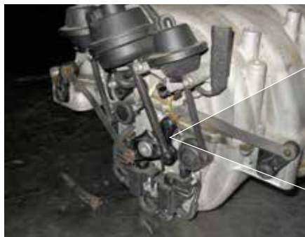
Obraz uszkodzenia: pęknięcie mechanizmu sterującego
