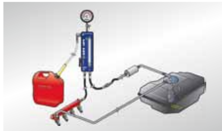
Пример: измерительное устройство в топливной системе с обратным потоком
