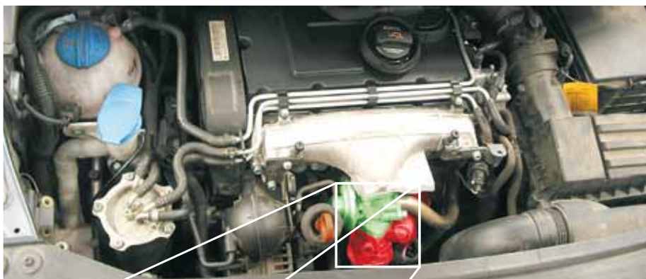
Pohled na část motoru vozu Touran – Zeleně vyznačená část: AGR ventil – Červeně vyznačená část: škrtící klapka
