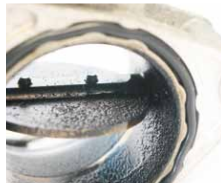
Regulační klapka trpící znečištěním olejem
