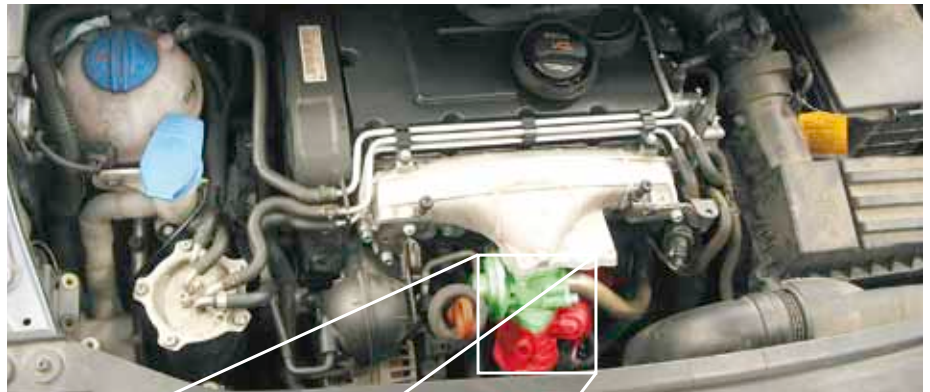
Vista sobre el recinto de motor del Touran resaltada en verde: V lvula de recobro de los gases de escape resaltada en rojo: Mariposa de r gula
