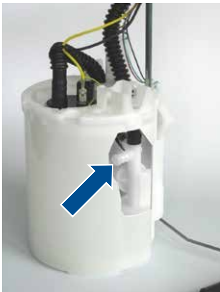
Fig. 1 : Vue dans le module d'alimentation en carburant (découpé) avec bouchon
