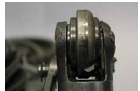
Obraz uszkodzenia: jednostronnie starty wałek bieżny
