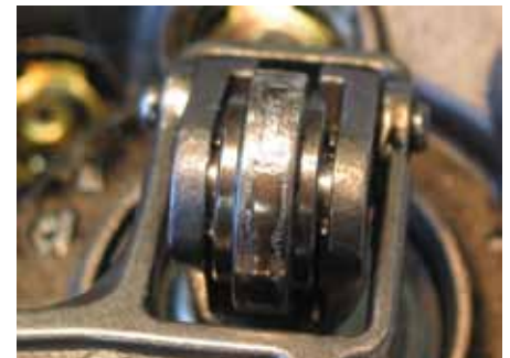
Obraz uszkodzenia: Wałek bieżny z karbami spowodowanymi przez zużyłą tarczę krzywkową
