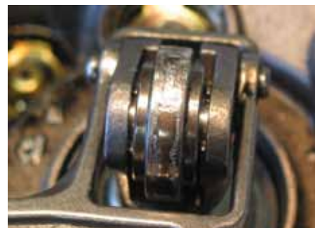
Картина повреждения: приводной ролик с насечками (питтинг) из-за изношенного эксцентрика
