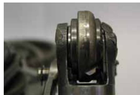
Картина повреждения: сточившийся только с одной стороны приводной ролик
