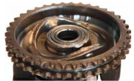
Disco de leva desgastado
