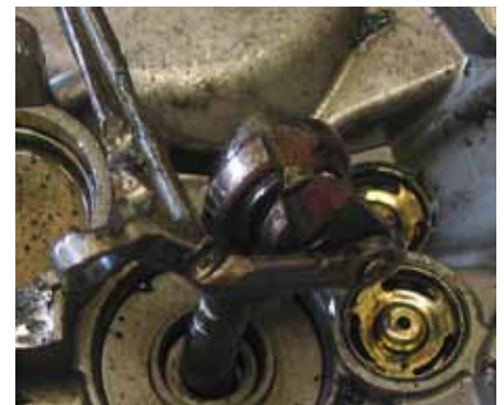
Schadensbild: Komplet zerstörter Schlepphebel
