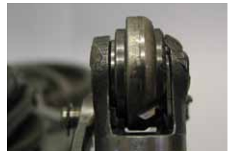
Schadensbild: einseitig abgeschliffene Laufrolle
