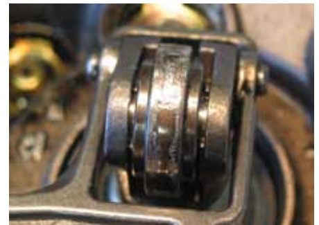
Schadensbild: Laufrolle mit Kerben (Pittings) durch verschlissene Kurvenscheibe
