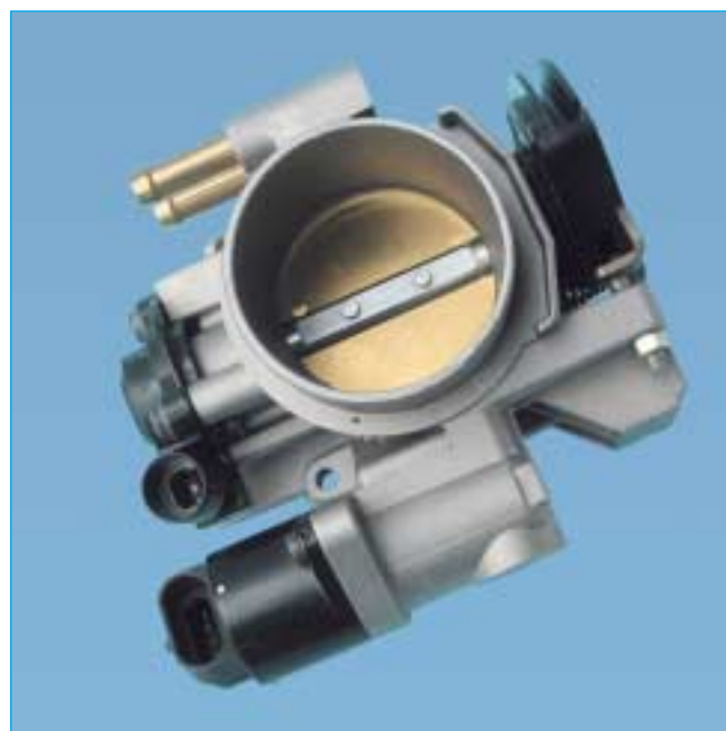
Válvula de mariposa con regulación del ralentí mediante un motor de paso a paso
