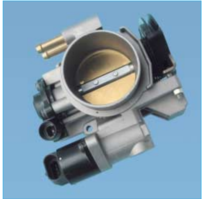
DKS mit Leerlauf-Füllungsregelung durch einen Schrittmotor
