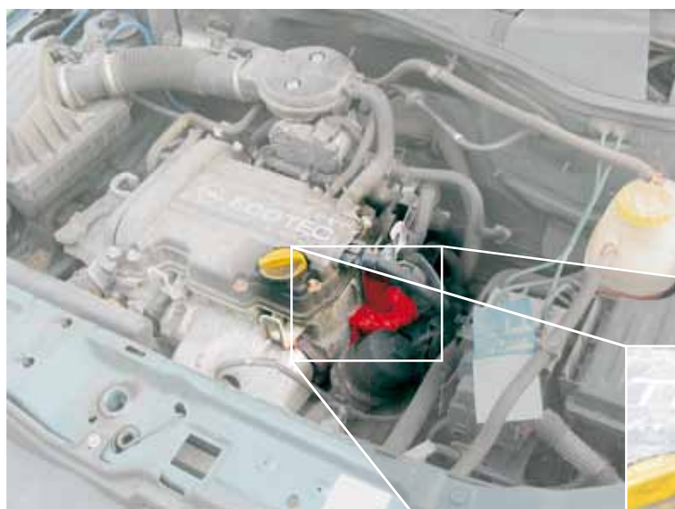
Elektryczny zawór EGR w Oplu Corsie (zaznaczony)
