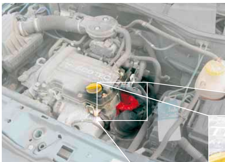
Válvula EGR eléctrica en el Opel Corsa (en primer plano)
