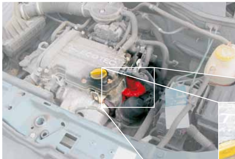
Valvola EGR elettrica in una vettura Opel Corsa (evidenziata)
