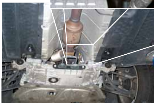
Schubumluftventil im VW EOS TFSI (rot hervorgehoben)
