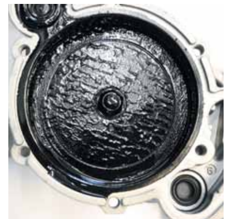
Fig. 3: Lodo de aceite en la bomba de vacío del VW Transporter produce ruidos de tableteo
