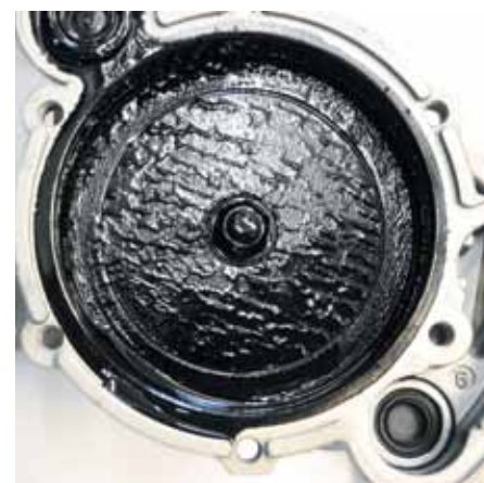
Fig. 3 : boue d'huile dans la pompe à vide du VW Transporter à l'origine de claquements
