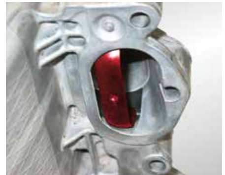
Clapet tumble (en rouge) pour le mode charge stratifiée
