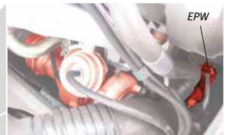
Exemple : turbocompresseur à ailettes à géométrie variable et EPW (signalé en rouge) sur une Audi A4 TDI.
