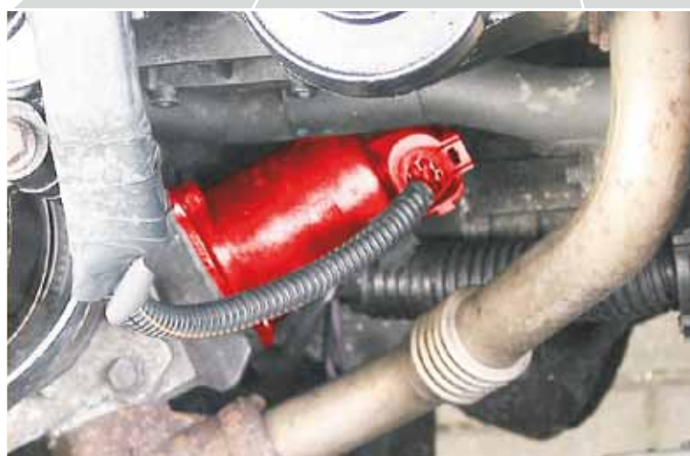
Válvula EGR en Renault Master JD1M (resaltada)
