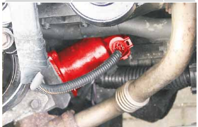
AGR-Ventil im Renault Master JD1M (hervorgehoben)
