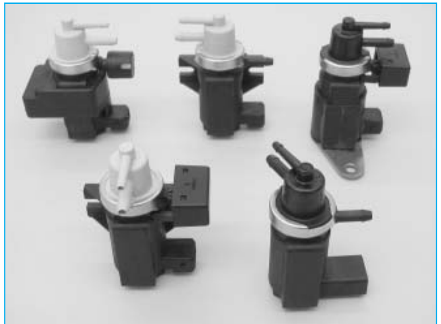
Rys. 1 Widok zewnętrzny EPW
