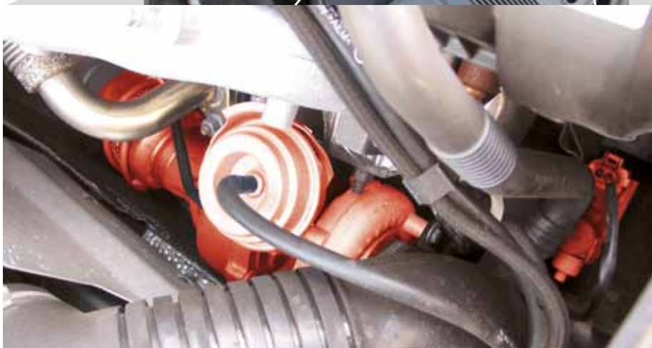
Elektropneumatyczny przetwornik ciśnienia i sprężarka VTG (czerwone) w pojeździe Audi A4 TDI
