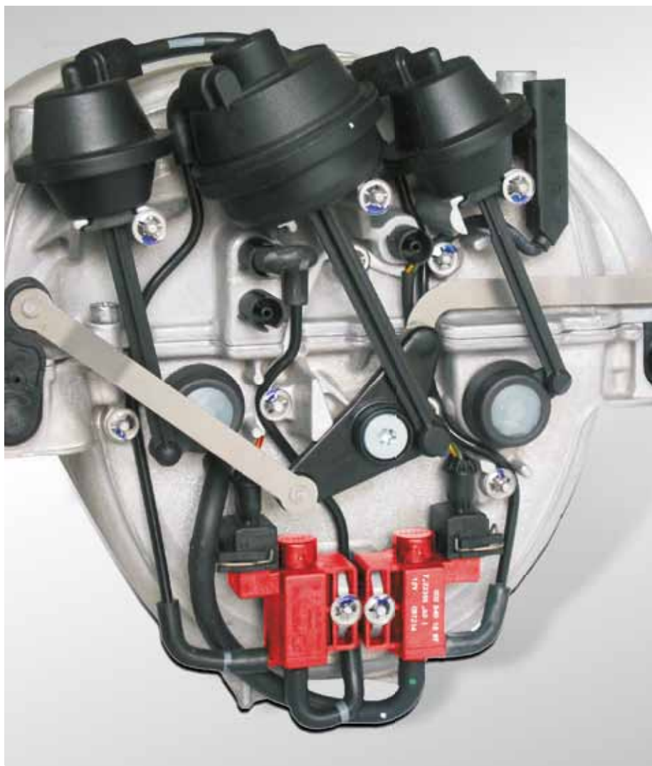
Exemplo de aplicação: Tubo de aspiração com válvulas electropneumáticas (destacado a vermelho) no Mercedes Classe C
