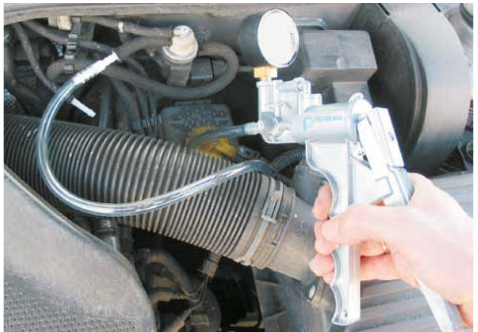
Comprobación de un convertidor electro-neumático de la presión con la bomba manual de vacío (VW Golf IV)
