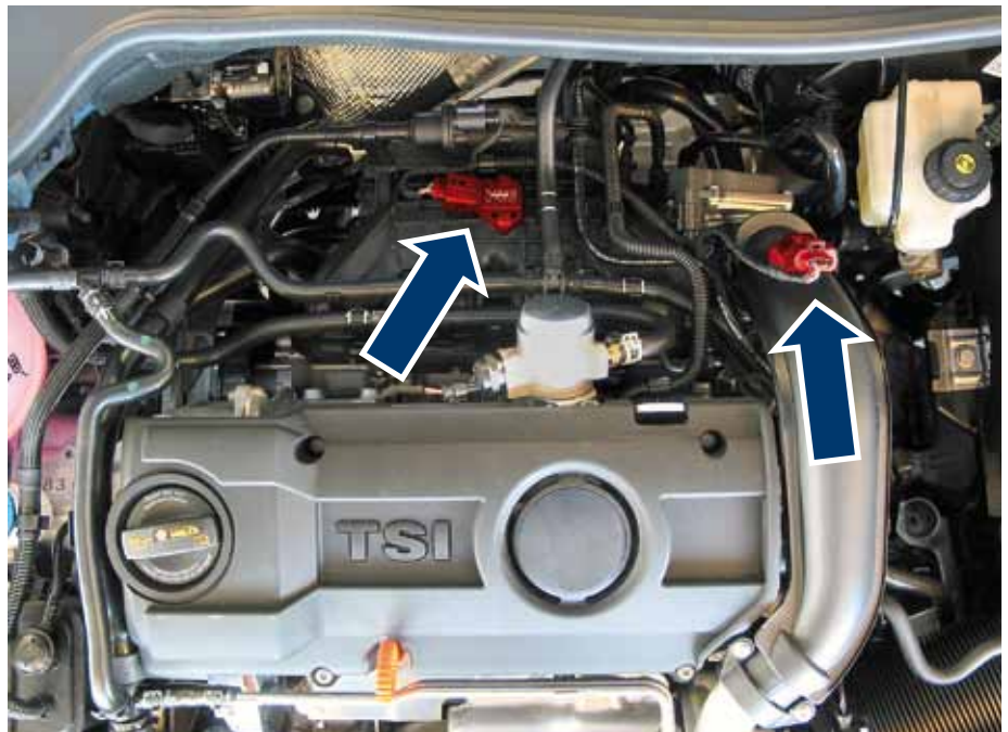
Fig. 2 Sensores de presión en el tubo de aspiración (rojos) en el VW Golf IV
