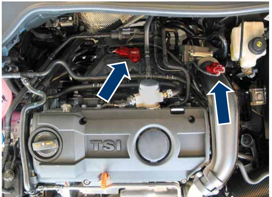
Abb. 2 Saugrohrdrucksensoren (rot) im VW Golf IV
