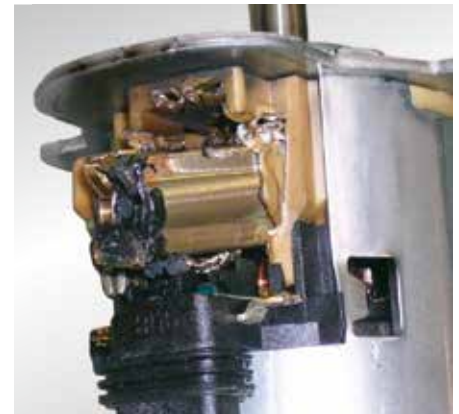
Obraz uszkodzenia: ślady nadtopienia na silniku elektrycznym albo na stykach elektrycznych
