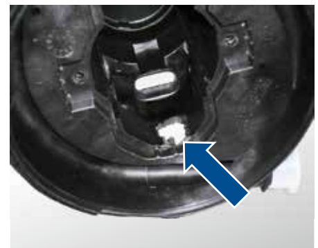
Obraz uszkodzenia: ślady nadtopienia na obudowie (patrząc od góry do wewnątrz obudowy)
