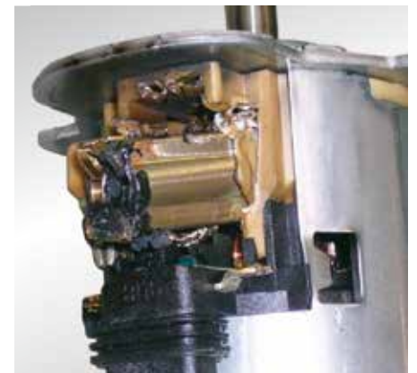
Картина повреждения: следы плавения на электродвигателе или на электрических контактах
