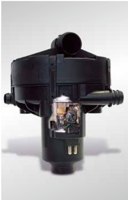
Vista de la bomba de aire secundario (corte) con huellas de fundición
