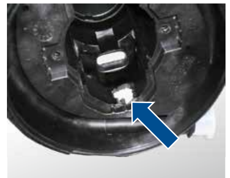
Manifestación de la avería: huellas de fundición en la caja de la bomba (la caja vista desde arriba)
