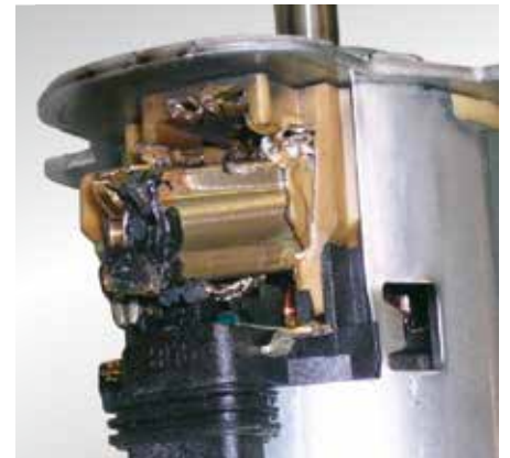
Manifestación de la avería: huellas de fundición en el motor eléctrico o en los contactos eléctricos
