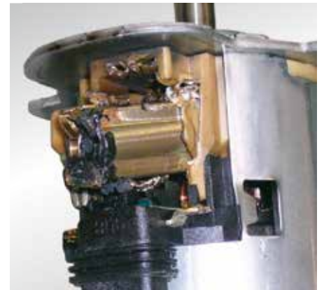
Vue du dommage : traces de fusion sur le moteur électrique ou les contacts électriques
