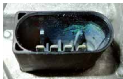
Wtyczka montażowa ze śladami korozji
