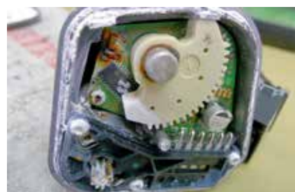
Взгляд внутрь поврежденной регулирующей заслонки
