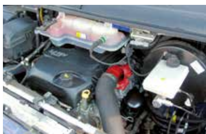
Регулирующая заслонка (выделена красным цветом) в моторном отделении Iveco Daily 3.0 л
