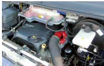
Mariposa de regulación (destacada en rojo) en el compartimiento del motor de un Iveco Daily 3.0 l
