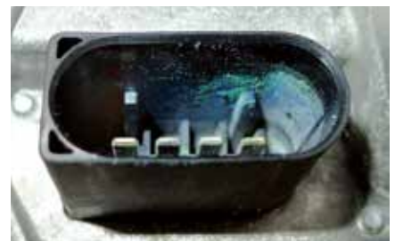
Conector de montaje con restos de corrosión
