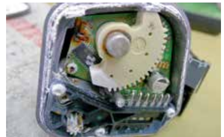
Vista del interior de una mariposa de regulación dañada
