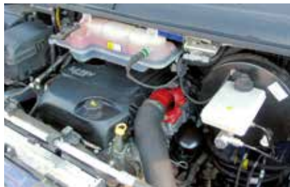
Valve de réglage (en rouge) dans le compartiment moteur d'un Iveco Daily 3.0 l
