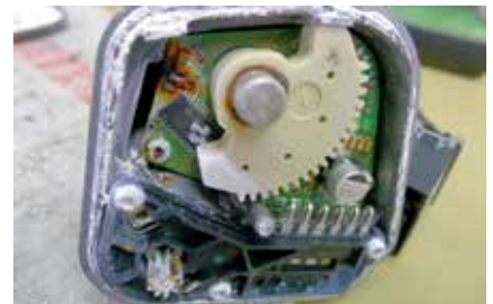
Vue de l'intérieur d'une valve de réglage détériorée
